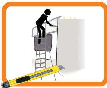
10. Wenn die Abstände oder Fugen an einigen Bereichen zu schmal sind, dann können Sie nach der Montage noch nachschneiden. Dazu einen vorsichtigen, tiefen Schnitt machen, ohne den Lack zu beschädigen. Den weichen Schaumstoff vollständig abziehen, den Kleber der Matte mit einem mittelharten Kunststoff abschaben.
