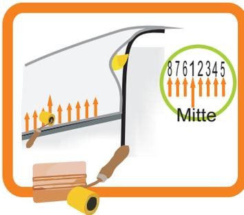
8. Die Matte mit Raker oder Rolle festdrücken, hierbei in der Mitte anfangen. Von der Mitte aus zu den Rändern rakeln. Nicht waagrecht, sondern in **senkrechten, sich überlappenden** Bewegungen das Raker oder die Tapezierrolle von der **Folienkante** aus nach **oben**, Richtung Schutzpapier schieben (vermeidet Blasenbildung). Von der Mitte aus langsam und gründlich zu beiden Rändern vorarbeiten, an den Rändern gründlich festdrücken.
