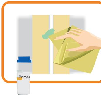
13. Primer (empfohlen: Sika Primer-215) mit Tuch auf den 1 mm breiten Streifen zwischen Fuge und Kreppband und in die Fuge bringen, damit das SikaFlex auf der Matte und in der entstandenen Rinne besser hält.
