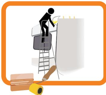
9. Weitere 20 cm des Schutzpapiers abziehen und nach hinten umschlagen. Rakeln Sie diesen Teil genauso wie oben beschrieben fest, immer mit senkrechten, überlappenden Strichen. Gehen Sie so vor bis das gesamte Trägerpapier unter der Matte hervorgezogen ist und die komplette Bahn festgedrückt ist.
