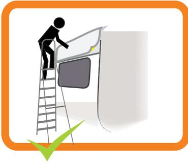
5. Leitern zu beiden Seiten des Wohnwagens positionieren. Matte mit dem Schutzpapier nach **unten** an die entsprechende Stelle legen und Ausschnitte und Position final überprüfen. Darauf achten, dass an allen Rändern und Stoßstellen **5 mm Abstand** für die spätere Versiegelung gegeben ist.
